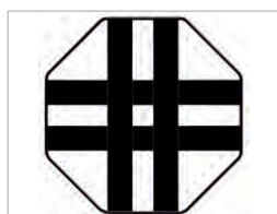
Base de apoyo para tanque
